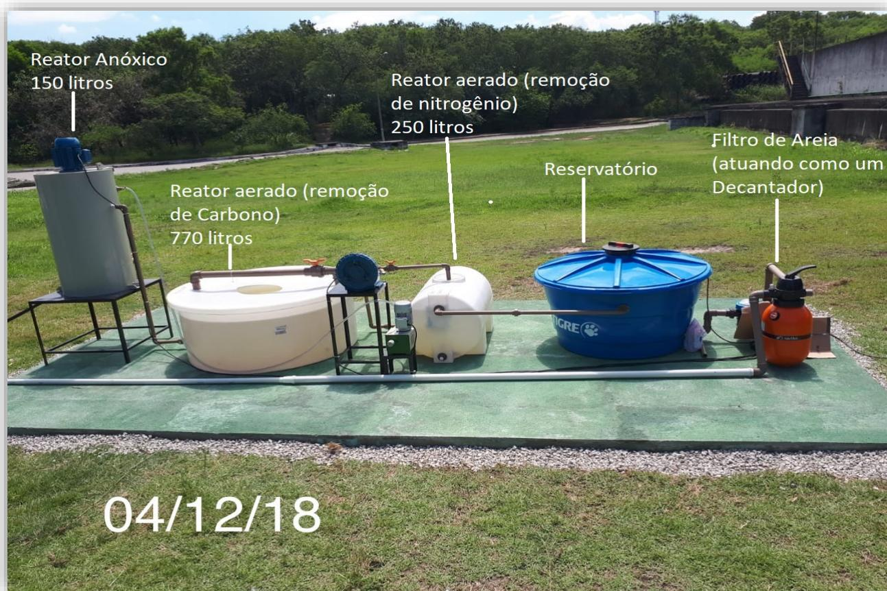
*Figura 3 - Reator Piloto Monera - Instalado ETE Alegria / CEDAE / RJ*
